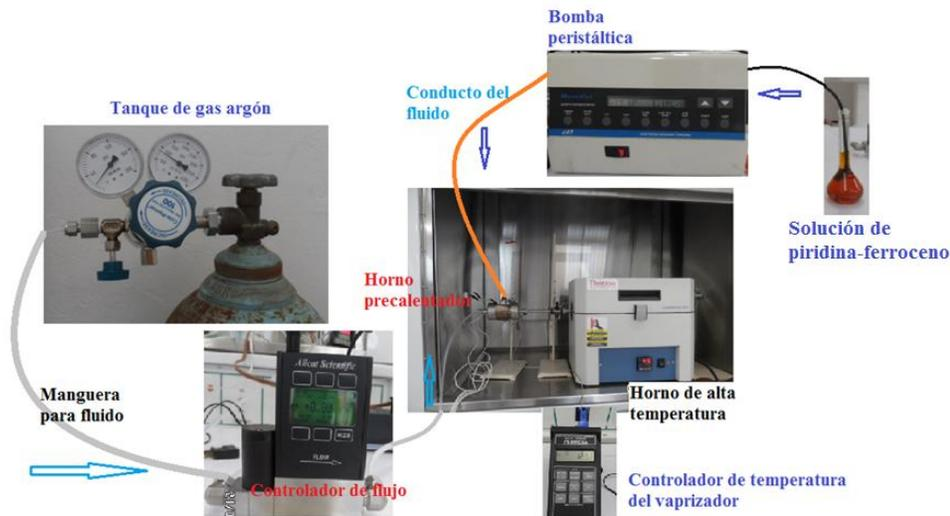
Figura 3.1 Instalación de los equipos y accesorios para el experimento de síntesis de NTC-N.
